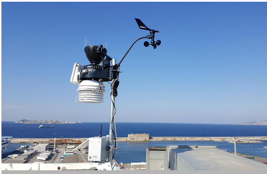
Figure 20 : Station météo communicante posée en toiture du Mirabeau2 par Enertech.
