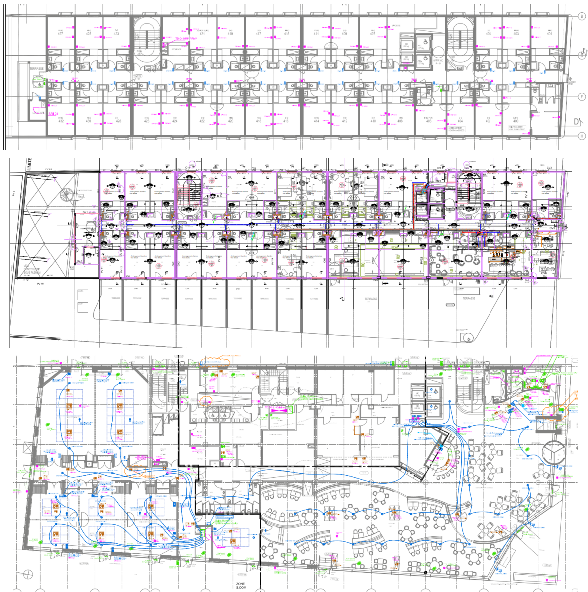
Figure 6 : Plans de niveau du bâtiment Golden Tulip (de haut en bas : étage courant, R+2, RDC).
