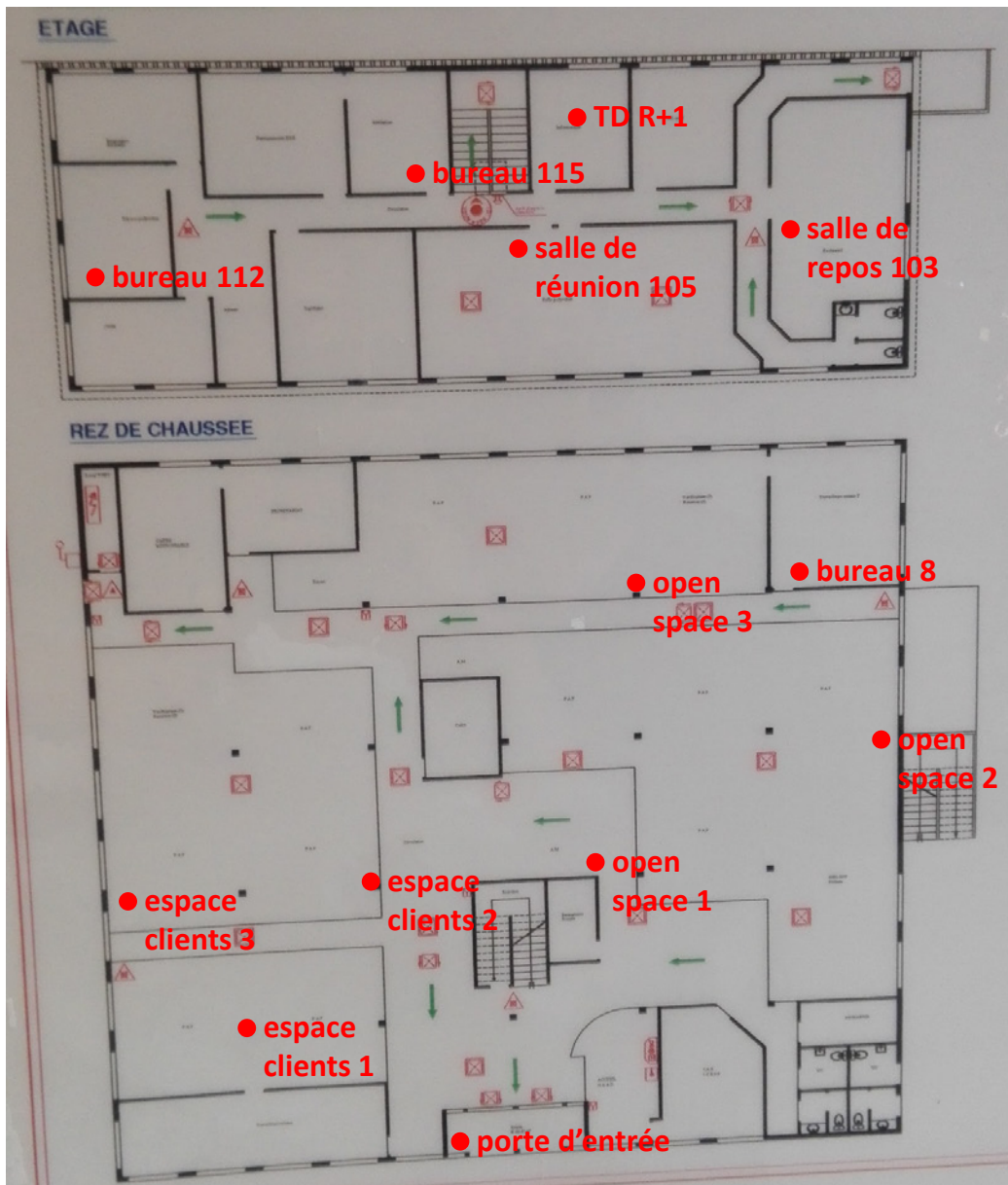
Emplacement des sondes de température au rez-de-chaussée et au R+1 du bâtiment
